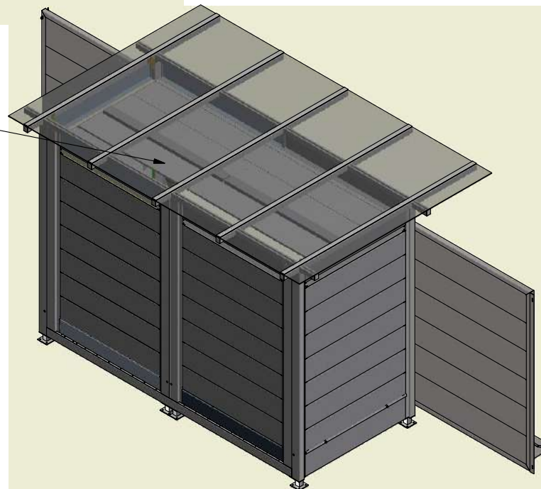
PANELES INTERNOS EN LAMINA DE ACERO GALVANIZADO PINTADOS MEDIANTE PINTURA ELECTROSTATICA
