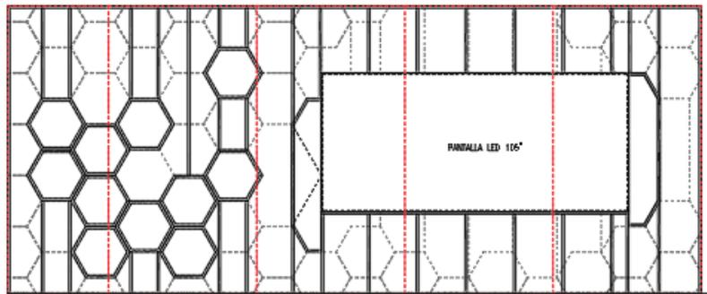
ELEVACION ESTRUCTURA INTERIOR MDF 18MM
